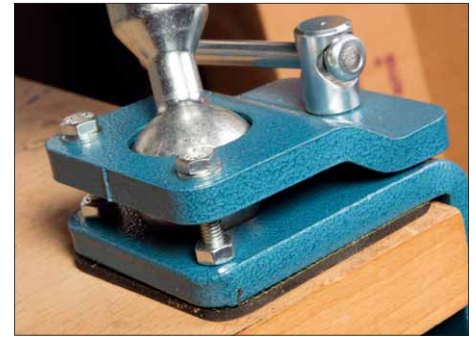
Über die beiden M6-Schrauben kann die Klemmung nachgestellt werden
