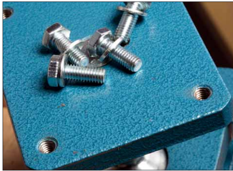
Metallbau wie er sein soll. Die Gewindebohrungen auf der Trägerplatte sind sogar angesenkt
