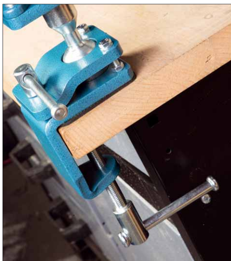
Die Tischklammer kann an Arbeitsplatten zwischen 20 und 50 mm Stärke befestigt werden
